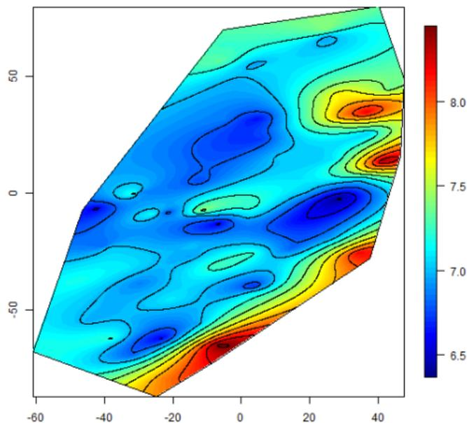
**Figura:** Distribuição espacial do pH. Valores interpolados com correção da anisotropia geométrica
